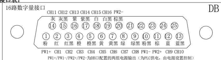
注: 使用 MTL4514/4614 时, 只安装 15 块隔离栅, 第 16 路为 LFD 输出。
